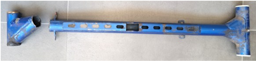
Obrázek 1 Přední podvozková noha s ulomeným dolním koncem.
