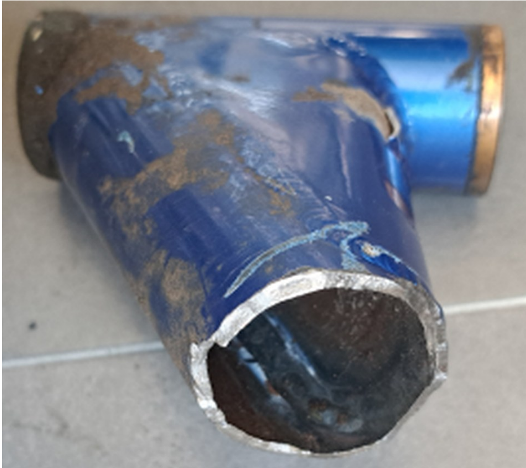
Obrázek 3 Lomová plocha na dolní uloměné části nohy
