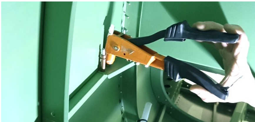
Obrázek 9 Nasuňte nýt do otvoru
