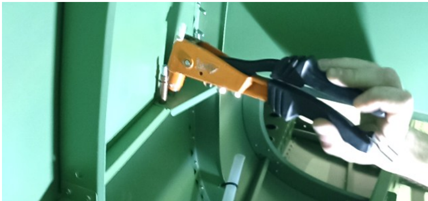
Obrázek 10 Nainstalujte nýt. U ostatních chybějících nýtů mezi agrafami postup opakujte.
