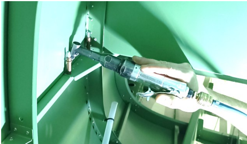
Obrázek 7 Otvory pro nýty převrtejte pomocí úhlové ruční vrtačky s vrtákem 3,2 mm. Práci provádějte přes kontrolní otvor na spodní straně trupu.
