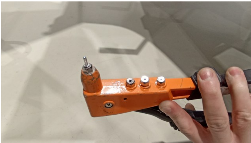
Obrázek 8 Vložte nýt do ruční nýtovačky
