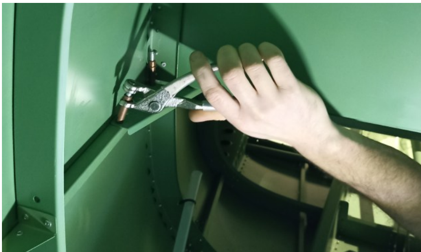
Obrázek 11 Kleštěmi odstraňte agrafy. Poté nainstalujte zbývající nýty.
