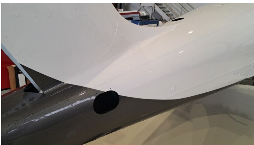
Obrázek 2 Kontrolní otvor (po odstranění krytu) na pravé straně trupu. Pokud letoun nemá kontrolní otvor na horní straně trupu (Obrázek 1), pak lze ke kontrole trupu použít tento otvor.
