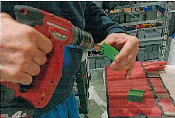
Převrtejte otvory v nových konzolách vrtákem 5mm.
