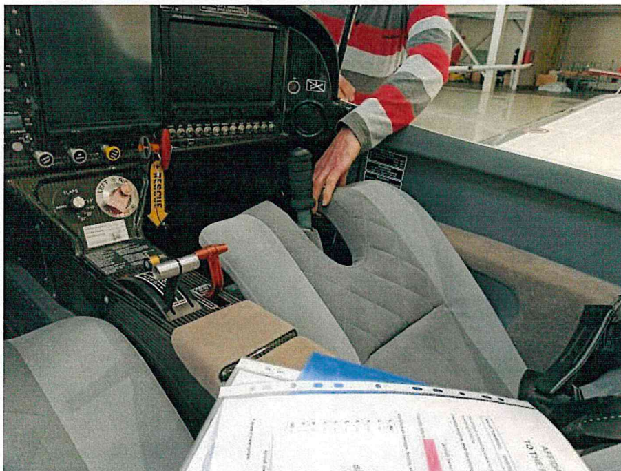
Obrázek 3 Pokud lze sedák poměrně lehce pozvednout nahoru, jedná se o původní provedení uchycení sedáku s rovnými konzolami.
