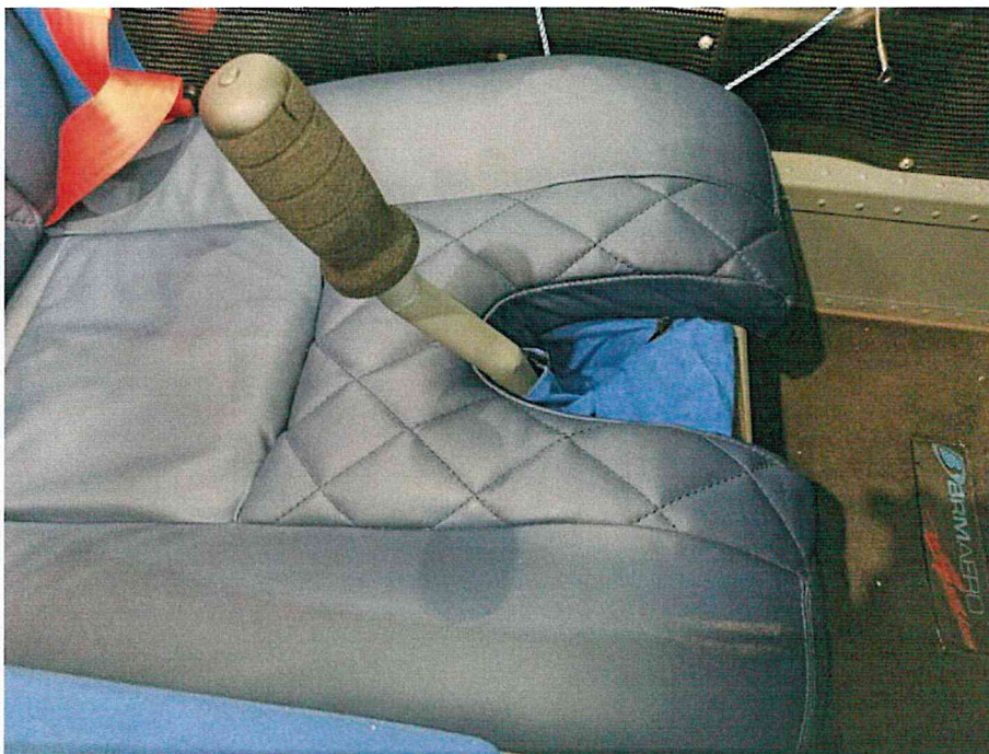
Obrázek 5 Výchylka řídicí páky ve směru plně přitaženo pokud je sedák správně nasazen (konzoly za nosníkem centropoplánu).
