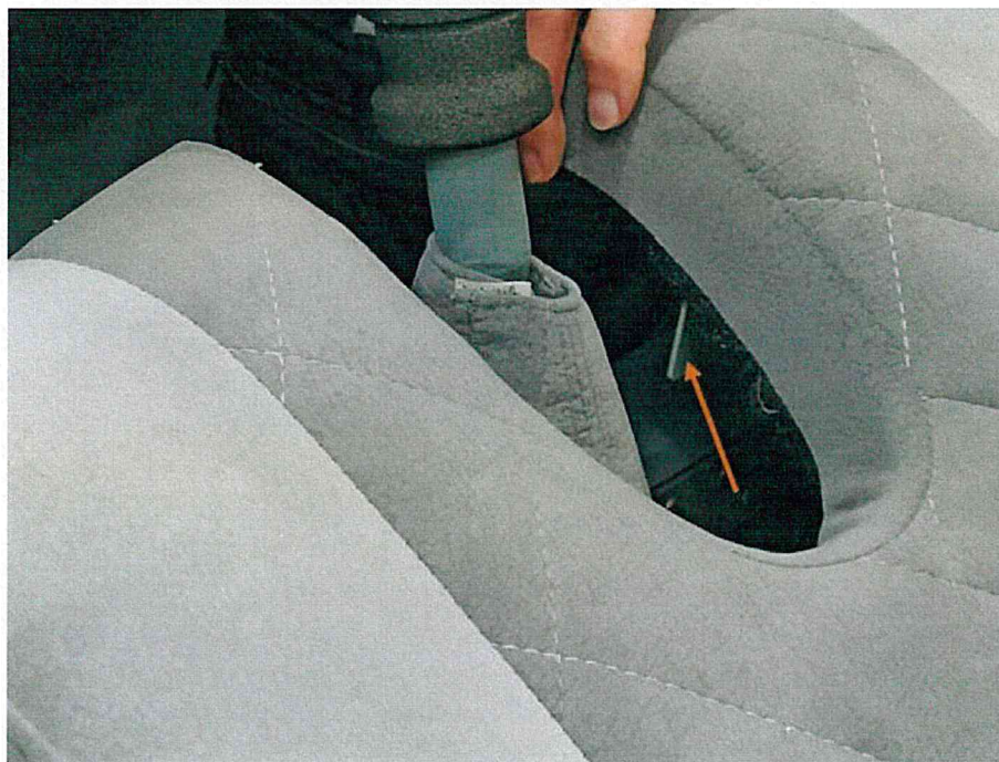
Obrázek 4 Detailní pohled, šipka označuje rovnou konzolu
