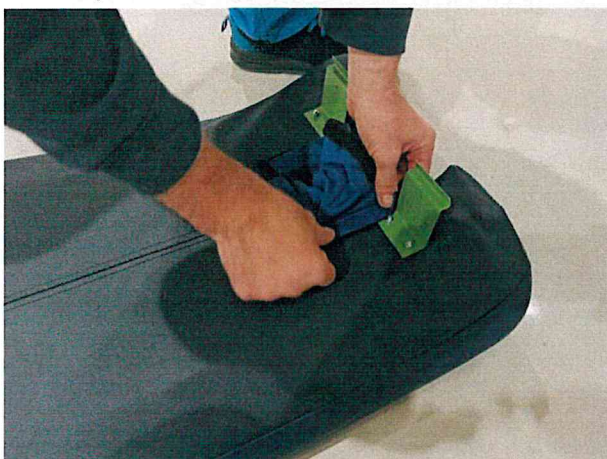
Nainstalujte punčošku řídicí páky na suché zipy sedáku.
