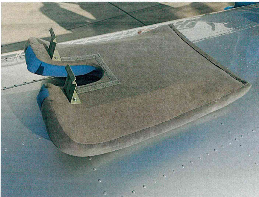
Obrázek 2 Nové provedení konzol pro uchycení sedáku sedačky
