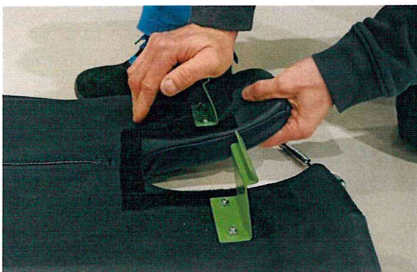
Pokud je potřeba upravit sílu, kterou sedačka v trupu drží, přihněte mírně konzoly požadovaným směrem - dozadu pro snížení přitlačné síly a snadnější nasazování, dopředu ve směru letu pro zvýšení síly, kterou sedačka v trupu drží.
