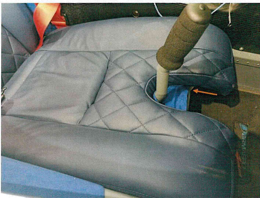
Obrázek 6 Omezená výchylka řídicí páky ve směru plně přitaženo, pokud sedačka přeskočí nahoru a dopředu (konzola se dostane před nosník, viz. šipka).
