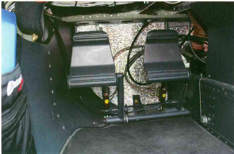
Entrambe le pedalieri sono dotate di comando idraulico differenziale dei freni
