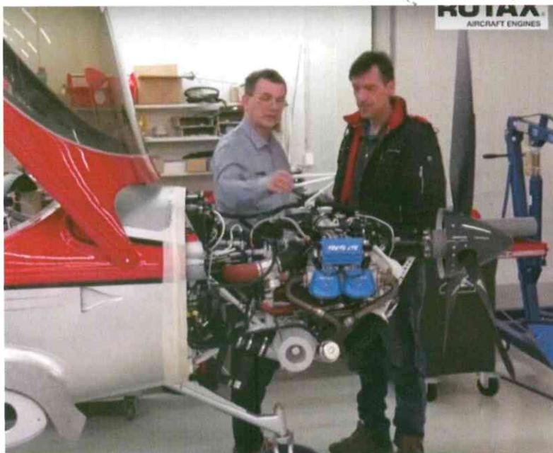
Il frame video che mostra l'installazione motore. Sul velivolo definitivo il radiatore acqua è stato spostato anteriormente
