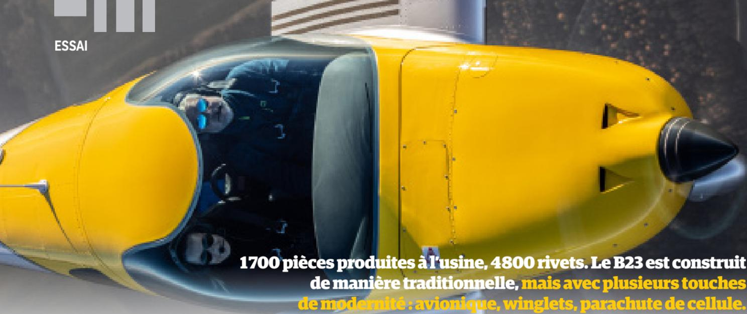
**1700 pièces produites à l'usine, 4800 rivets. Le B23 est construit de manière traditionnelle, mais avec plusieurs touches de modernité : avionique, winglets, parachute de cellule.**
