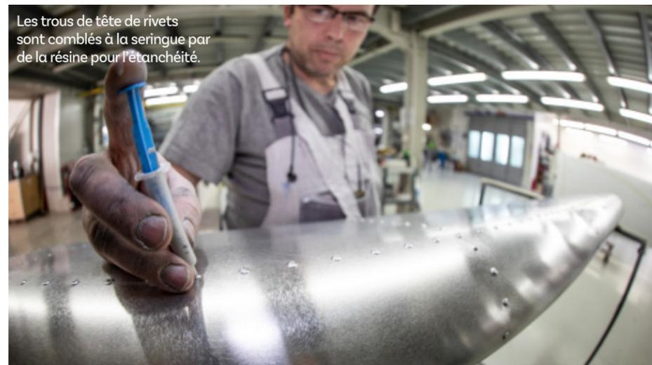
Les trous de tête de rivets sont comblés à la seringue par de la résine pour l'étanchéité.
